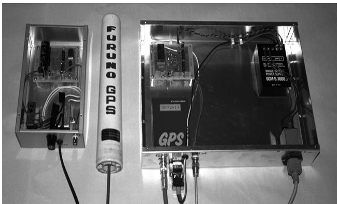
図 3.1: GN-72 本体を内蔵した GPS 1 秒信号発生器 (右),GN-72 のアンテナ (中) と水晶発振器の外観
