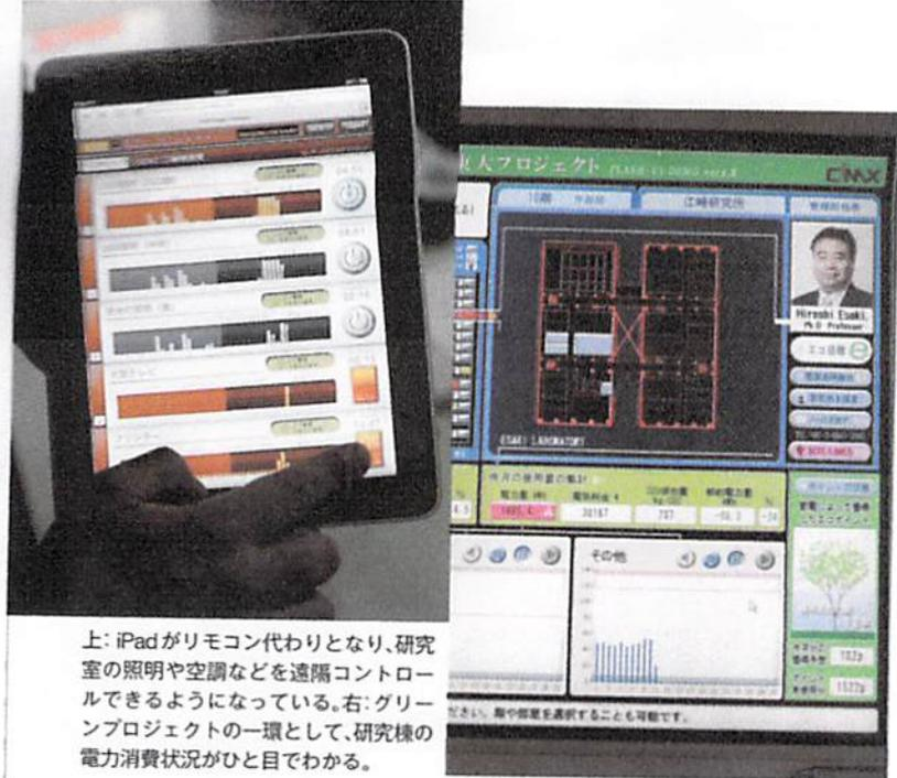
上: iPadがリモコン代わりとなり、研究室の照明や空調などを遠隔コントロールできるようになっている。右: グリーンプロジェクトの一環として、研究棟の電力消費状況がひと目でわかる。
