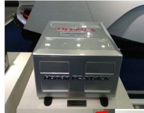
HONDA FCV 30 kW (持続) 100 kW (ピーク)
