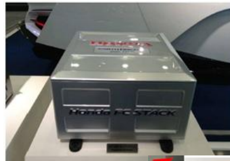
HONDA FCV 30 kW (持続) 100 kW (ピーク)
