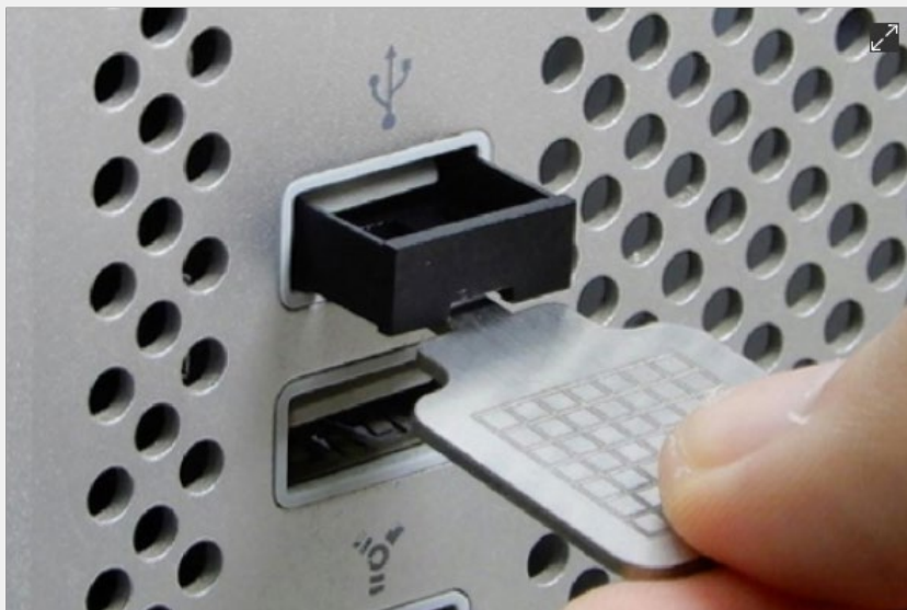
専用引抜ツールで引き抜く
